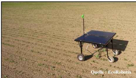
Abb.: Der autonome Jätroboter von EcoRobotix in einem Zuckerrübenfeld.
