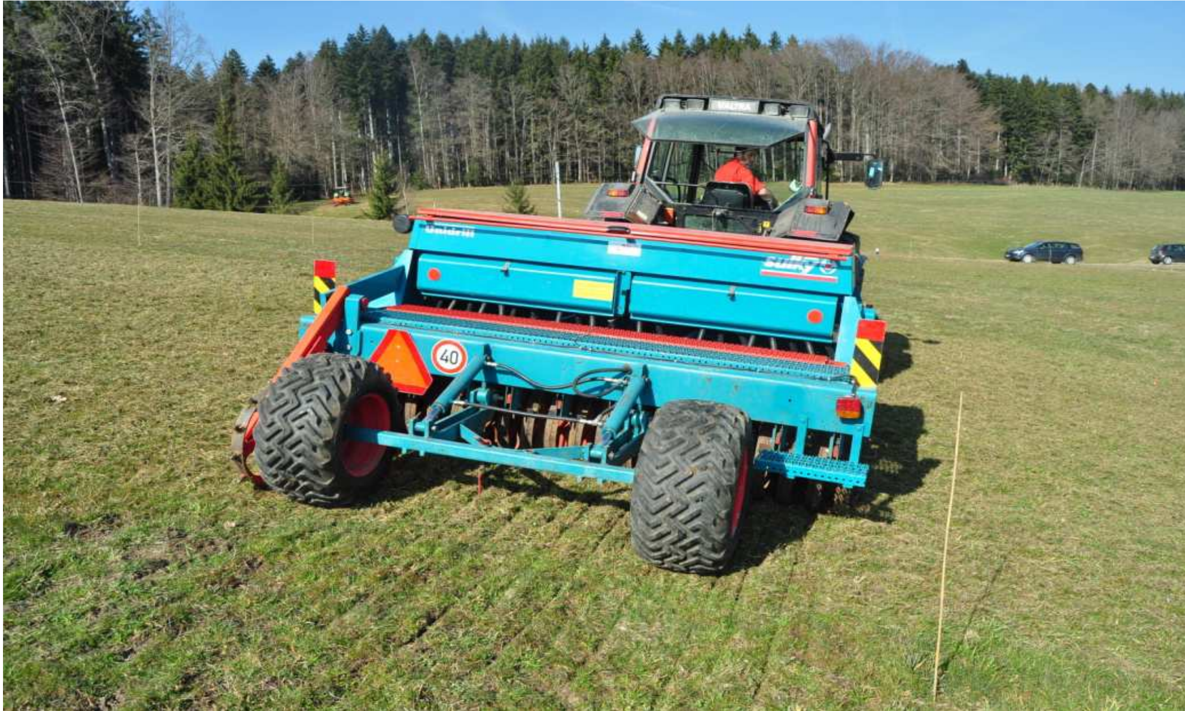
Sämaschine Sulky : Scheibenschar, Reihenabstand = 13.5 cm
