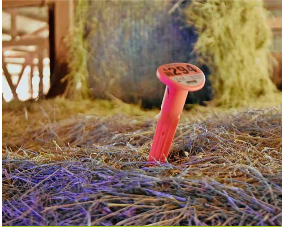
Les sondes permettent de suivre en temps réel la température du fourrage. L'éleveur reçoit également un SMS d'alerte dès qu'un niveau dangereux est atteint.
